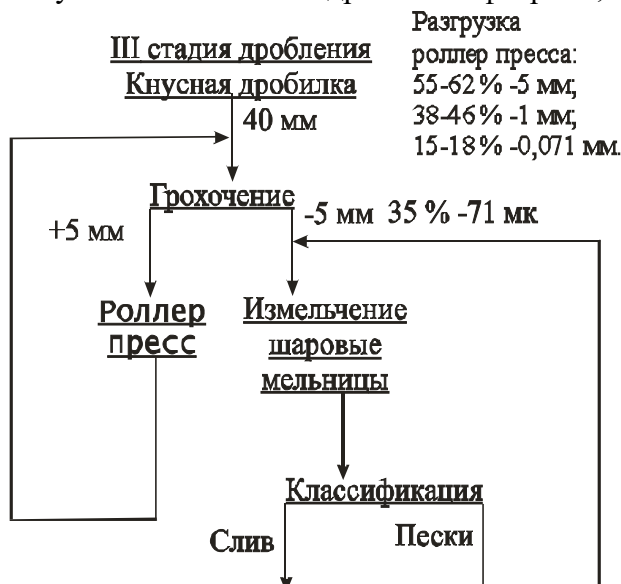
Рисунок 3. Схема опытно промышленных испытаний роллер пресса
