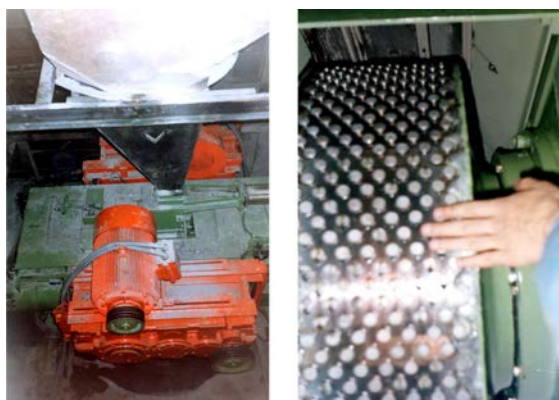
Рисунок 1 - Пилотный роллер пресс в сборе, валки пресса
