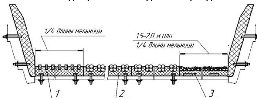
Рисунок 3 - Комплектация мельницы волновыми резиновыми футеровками различного исполнения
