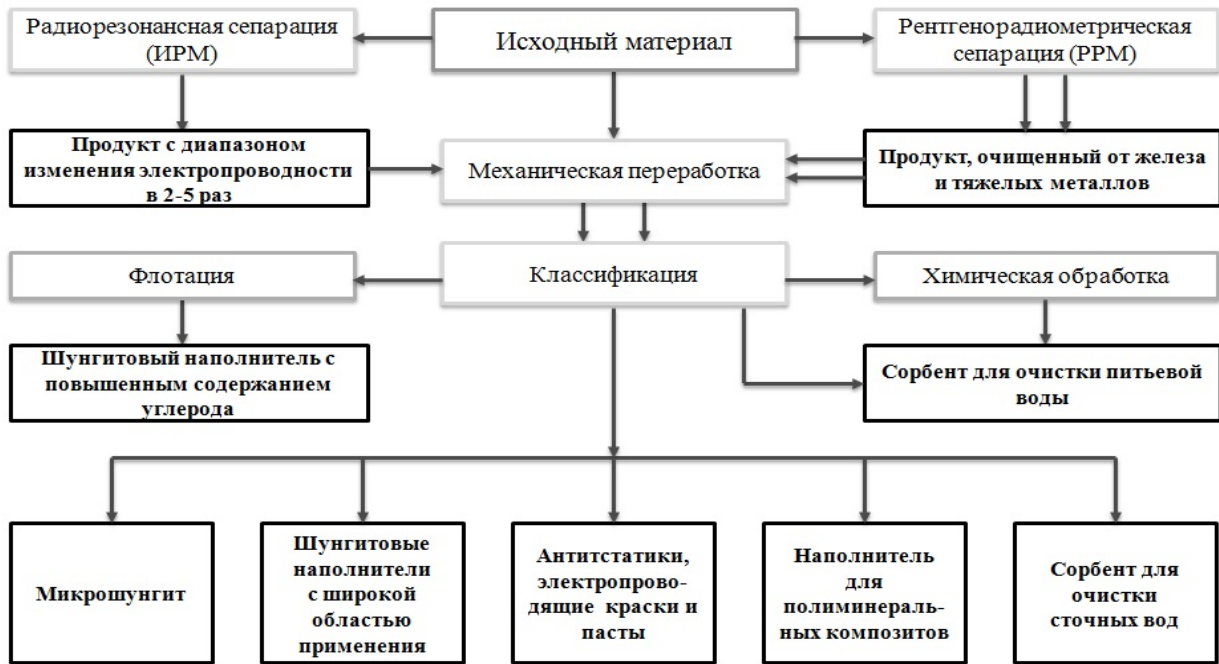
Рисунок – Блок - схема комплексной переработки шунгитового сырья
