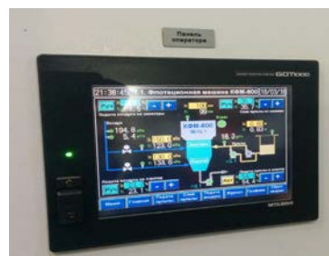
Рисунок 5 – Шкаф управления промышленной флотомашинной КФМ с сенсорной панелью
