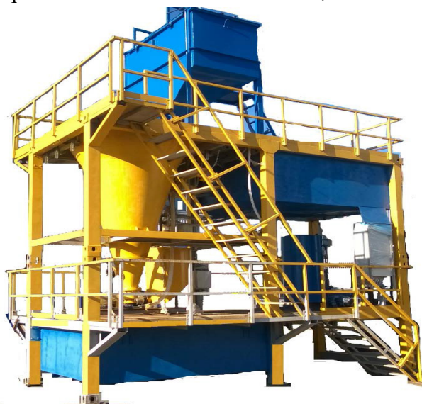
Рисунок 1 – Модульная установка интенсивного цианирования Август КШ-3
