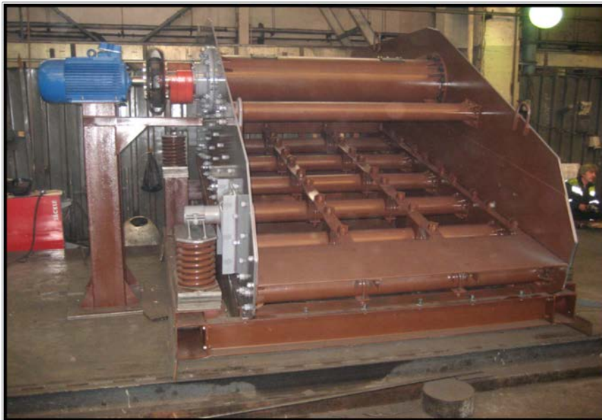
Рисунок 3 - Общий вид грохота ГИТ-51ДК для узлов шихтоподачи доменных цехов
