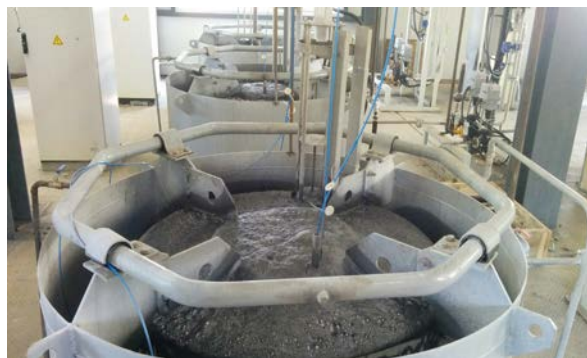
Рисунок 4 – Флотомашины КФМ-600 на МОУ-15 «Рудметал» АД, работающие в цикле свинцовой флотации
