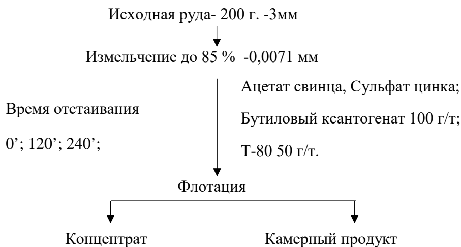
Рисунок 1 - Схема флотационного эксперимента с свинцово-цинковой рудой Горевского месторождения
