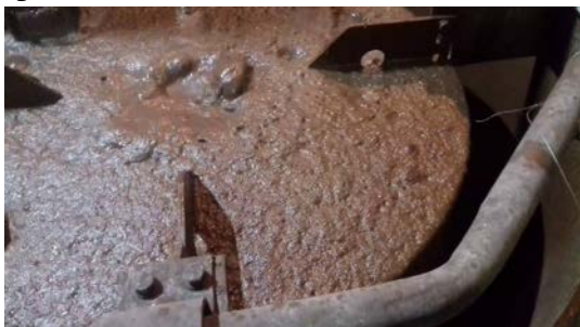
Рисунок 4 – Флотация цинковых кеков на флотомашине КФМ-600
